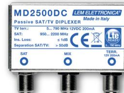
Miscelano i segnali della banda SAT con quelli della banda TV terrestre con una minima perdita di passaggio e con una separazione superiore a 50 dB. Quest'ultima caratteristica li rende idonei ad evitare interferenze tra le bande che possano compromettere la qualità dei segnali DTT in modulazione COFDM. Sono idonei anche ad essere utilizzati in impianti con distribuzione monocavo tipo SCR - dCSS.
